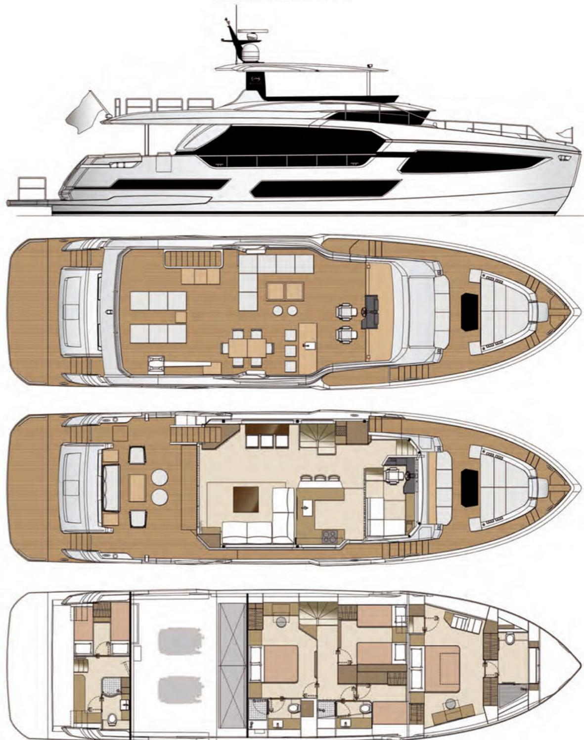
Eslora total | LOA 22.86 m (class CE-A) · Línea de flotación | Length waterline 20.62 m · Manga | Beam 6.20 m · Calado | Draft 1.72 m · Motorización | Engine 2 x MAN V8-1200CR / 1200HP · Generadores | Generators - 1 x Onan 17.5 kW (50 Hz) + 1 X Onan 22.5 kW (50 Hz) · Desplazamiento | Displacement 67 T · Capacidad combustible | Fuel capacity 9,085 l · Capacidad agua| Water capacity 1,136 l · Diseñador | Designer Cor D. Rover & Horizon Yachts · Astillero | Shipyard Horizon Yachts
